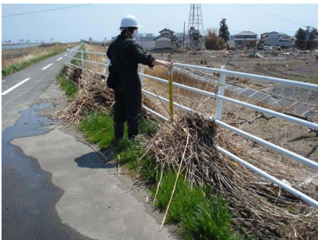
写真 2.2.1-19 堤外からの越流痕跡
