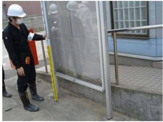
写真 2.2.3-17 周辺における浸水深測定
