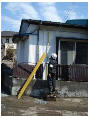
写真 2.2.1-25 周辺家屋の浸水深測定
