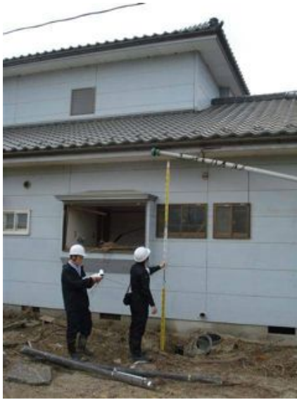
写真 2.2.1-13 堤防付近の浸水深測定
