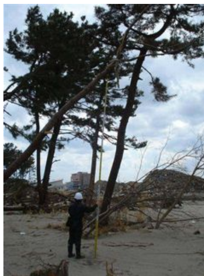
写真 2.2.5-2 打撃痕による浸水深の測定
