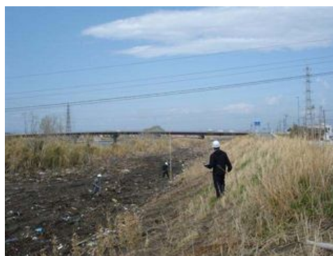
写真 2.2.1-24 右岸堤防の堤高測定
