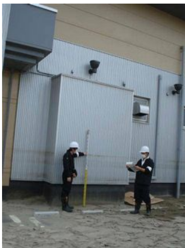
写真 2.2.4-9 浸水痕跡（浸水深）の測定
